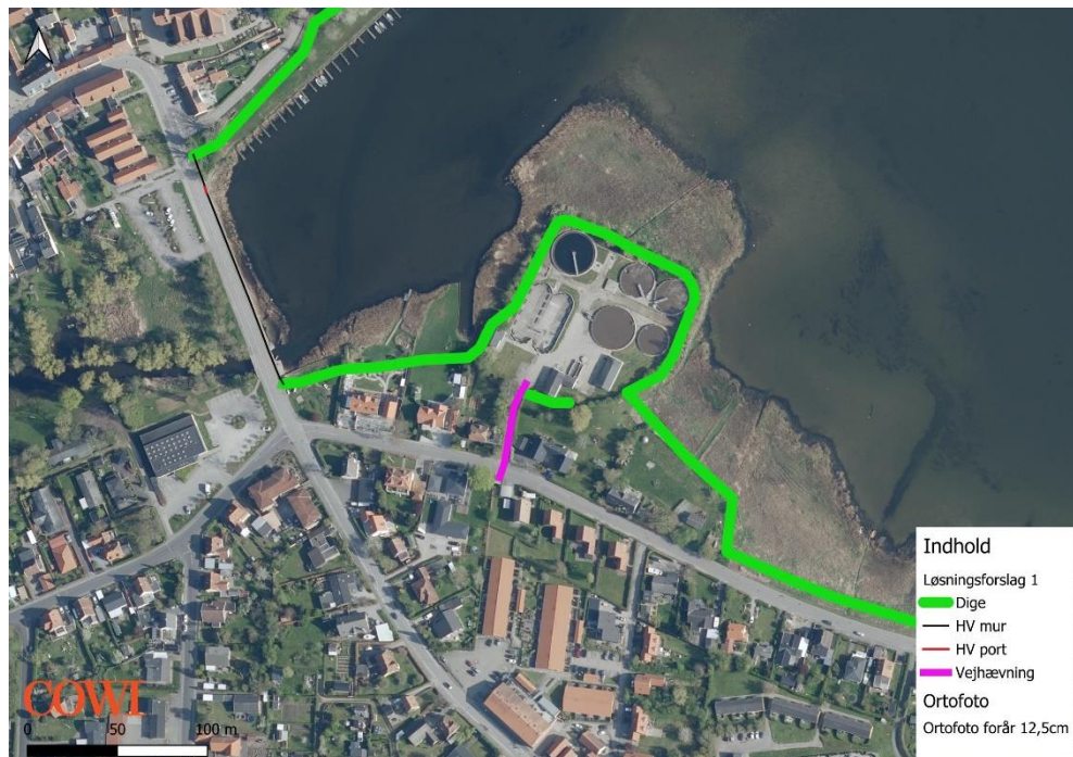
Figur 5-11 Oversigtskortet viser kystbeskyttelsestyperne i området omkring rensningsanlægget. Vejhævningen definerer områdefægrænsningen mellem områderne Præstø by og Hestehavevej, se Figur 5-1. Ortofoto forår 2024. Kilde: (Klimadatastyrelsen, u.d.).
