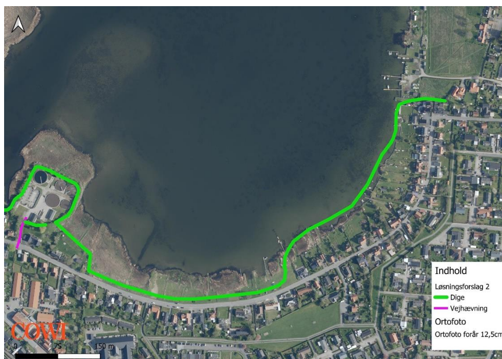
Figur 5-26 Oversigtskort over kystbeskyttelsestypen langs med Hestehavevej. Ved denne løsning er dele af diget rykket frem, så det ligger uden for de private bebyggede matrikler. Kilde: (Klimadatastyrelsen, u.d.).
