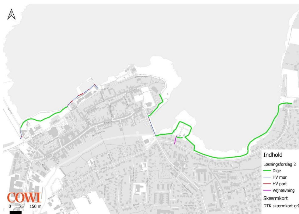
Figur 5-16 Oversigtskort, der præsenterer løsningsforslag 2, kortet er baseret på løsning tegnet i SCALGO. Kilde: (Klimadatastyrelsen, u.d.).
